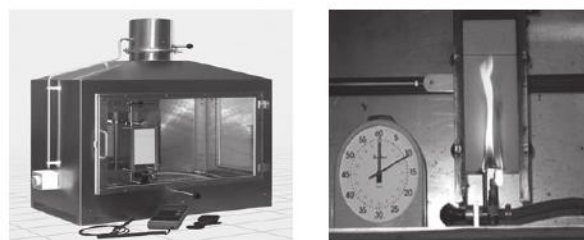
شکل ۱. تجهیزات و شیوه آزمون استاندارد EN ISO 11925-2
